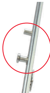
Pino com sistema antielevação na cremone que evita arrombamento, funcionando como uma alavanca
