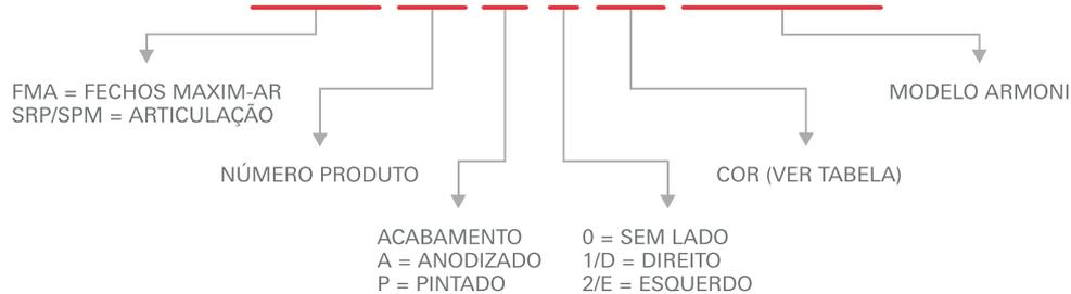
Obs.: Foram mantidas as características de instalação, usinagem e furações dos fechos existentes.
