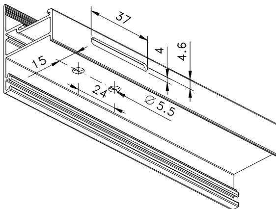
Detalhe de usinagem - sem escala
